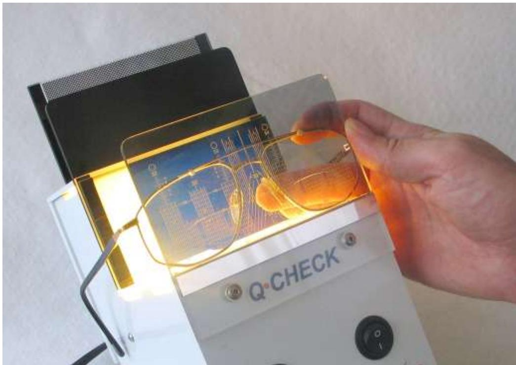
Fig. 3 Contrôle qualité professionnel de lunettes montées avec le Q-CHECK.
