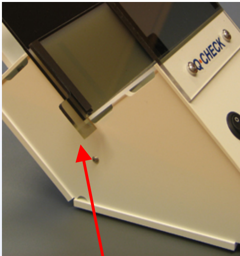
Position für die Spannungsprüfung
